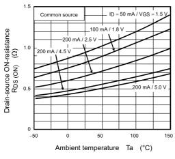
Fig. 7.1.5 R<sub>DS(ON)</sub> - T<sub>a</sub>
