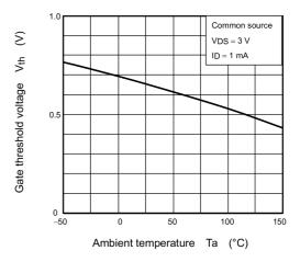
Fig. 7.1.6 V<sub>th</sub> - T<sub>a</sub>
