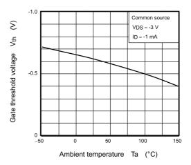
Fig. 7.2.6 V<sub>th</sub> - T<sub>a</sub>
