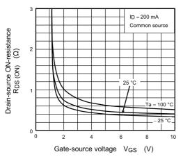
Fig. 7.1.3 R<sub>DS(ON)</sub> - V<sub>GS</sub>
