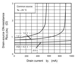
Fig. 7.1.4 R<sub>DS(ON)</sub> - I<sub>D</sub>
