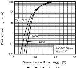
Fig. 7.1.2  $I_D - V_{GS}$
