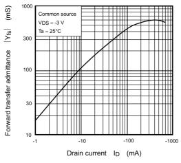
Fig. 7.2.7 |Y<sub>fs</sub>| - I<sub>D</sub>
