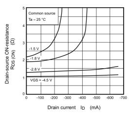
Fig. 7.2.4 R<sub>DS(ON)</sub> - I<sub>D</sub>
