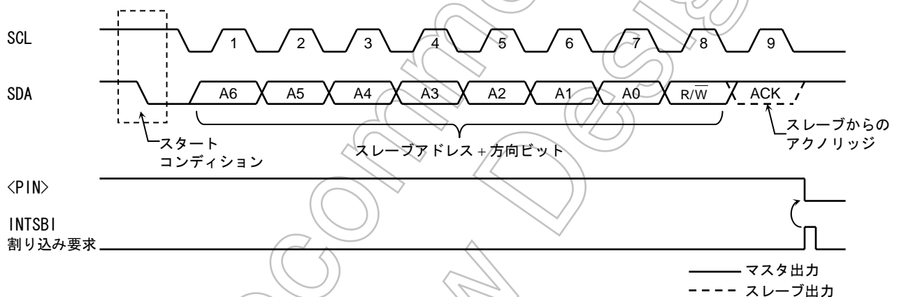
図 15.6.2.1 スタートコンディションとスレーブアドレスの発生
