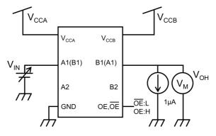
Fig. 15.1 Test Circuit
