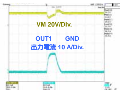
OUT1 地絡波形 OUT1-GND
