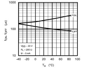
Fig. 12.1.8 t<sub>ON</sub>, t<sub>OFF</sub> - T<sub>a</sub>
