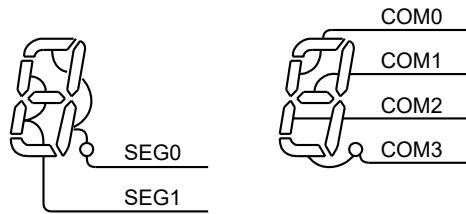
図 23-6 COM, SEG 端子接続例 (1/4 デューティ)
