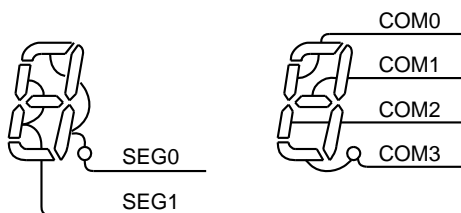
図 23-6 COM, SEG 端子接続例 (1/4 デューティ)
