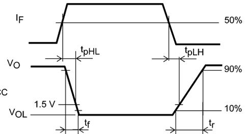
図 13.1.5 伝搬遅延時間測定回路, 波形
