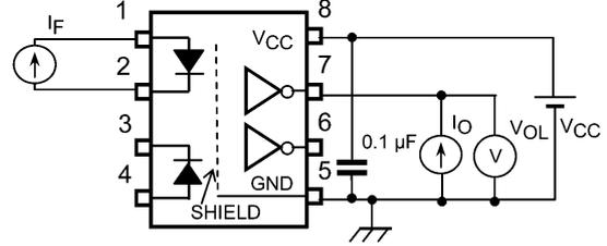
図 13.1.2 VOL測定回路
