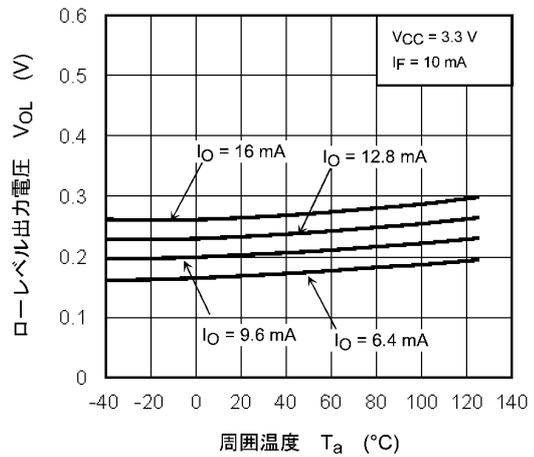
図 13.2.4  $V_{OL} - T_a$
