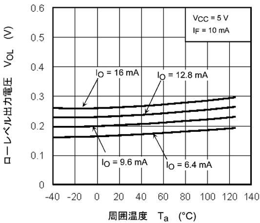
図 13.2.3  $V_{OL} - T_a$
