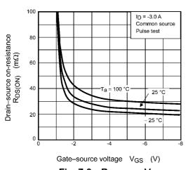
Fig. 7.3  $R_{DS(ON)}$  -  $V_{GS}$
