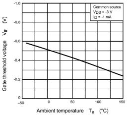
Fig. 7.6 V<sub>th</sub> - T<sub>a</sub>
