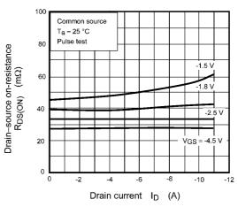
Fig. 7.4 R<sub>DS(ON)</sub> - I<sub>D</sub>
