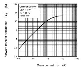
Fig. 7.7 |Y<sub>fs</sub>| - I<sub>D</sub>
