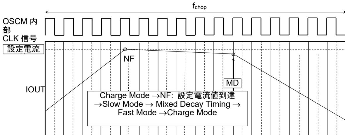
図 14 Mixed Decay Mode の電流波形と設定
