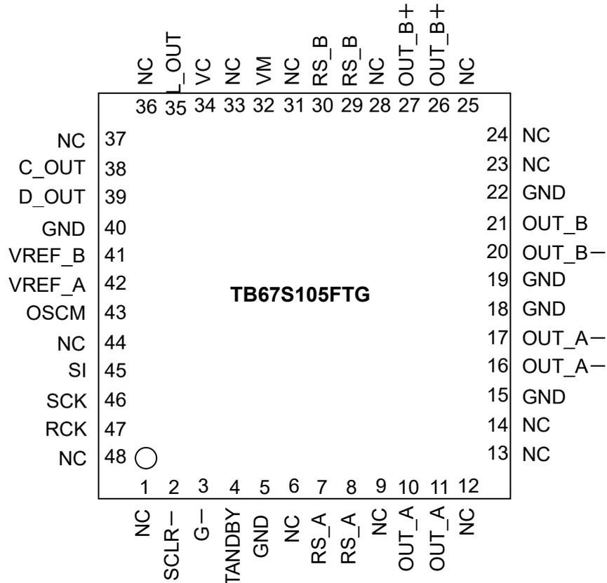
図3 ピン配置図
