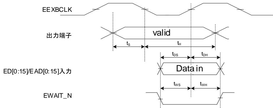
図 7.21 EEXBCLK同期セパレートバスモード/マルチプレクスバスモードタイミング
