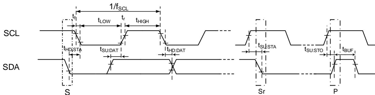
図 7.6 I<sup>2</sup>CインターフェースバージョンAのACタイミング
