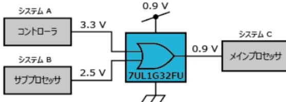
低電圧動作特性や、低い入力しきい値を持つ特性の応用でレベル変換+論理変換を実現します。
