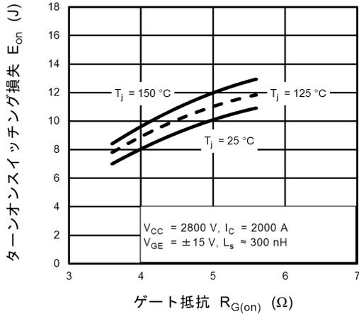
図 7.7  $E_{on} - R_{G(on)}$
