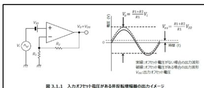
図 3.1.1 入力オフセット電圧がある非反転増幅器の出力イメージ
