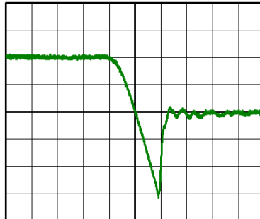
図 2.8 S-FRD t_{rr} 波形例
