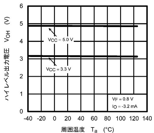
図 12.2.6  $V_{OH} - T_a$
