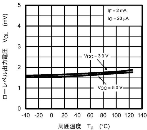
図 12.2.3  $V_{OL} - T_a$
