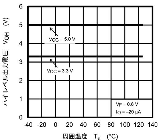
図 12.2.5  $V_{OH} - T_a$
