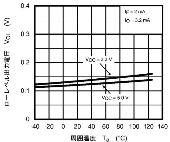
図 12.2.4  $V_{OL} - T_a$
