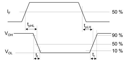
図 12.1.5 伝搬遅延時間測定回路, 波形
