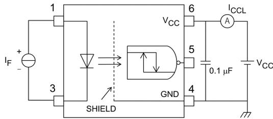
図 12.1.3 ICCL測定回路
