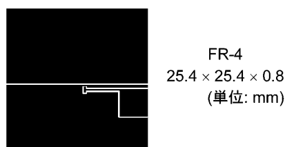
図 5.1 ガラスエポキシ基板 実装例a
