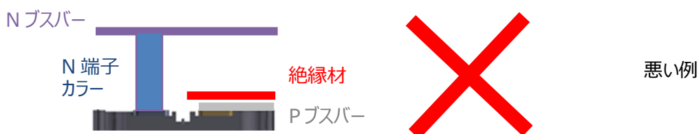
図 2.5.6 P と N の主回路配線部材の間隔をあけることにより、主回路インダクタンスが増加する例
