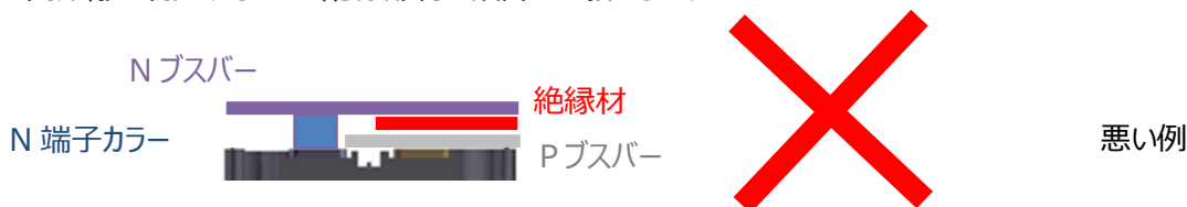
図 2.5.7 P ブスバーが N 側にずれることによって P-N 間絶縁距離が不足する例
