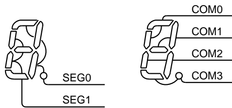
図 17-6 COM, SEG 端子接続例 (1/4 デューティ)
