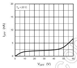
Fig. 12.1.9 I<sub>OFF</sub> - V<sub>OFF</sub>
