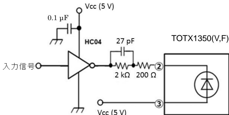
(3)  $I_F = 4 \text{ mA}$  駆動, TORX1355(V,F)使用時
