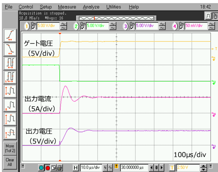
図 3.1.2 MOSFET のみで構成される出力波形例 (拡大)
