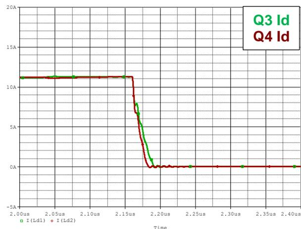
図 2.5.2 レイアウト非対称時波形(On 時)
