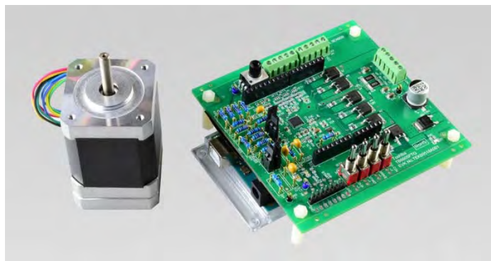
図 1-1 モータ制御 Closed-loop システム
