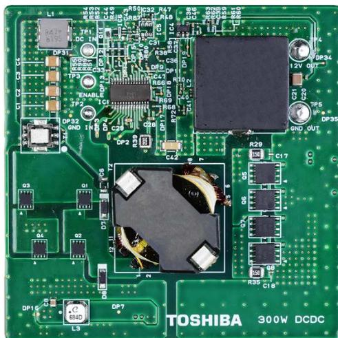
図 2.1 300W 絶縁型 DC-DC コンバータ外観
