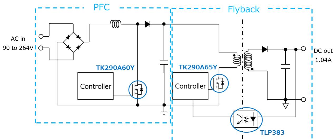
**Fig. 2.2 Block Diagram**
