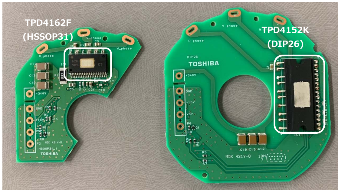
図 2.4 DIP26 製品 BLDC モーター駆動回路基板との比較
