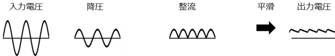
図 1.1 トランス方式 AC-DC 電源構成例
