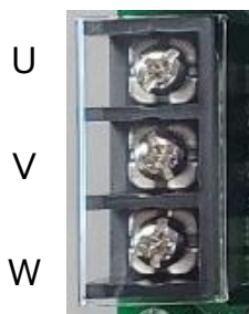
図 4.3 基板上のモーター接続端子(J2)
