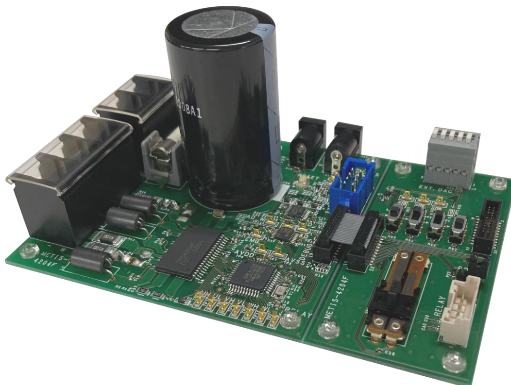
図 2.3 DC300 V 入カブラシレス DC モーターセンサーレス駆動回路 基板外観(RD179-3)
