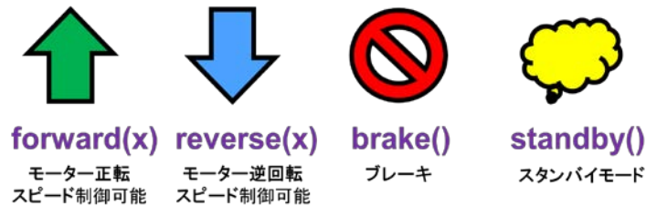
図 6-4 単体モーター単体制御向け Level 2 関数
