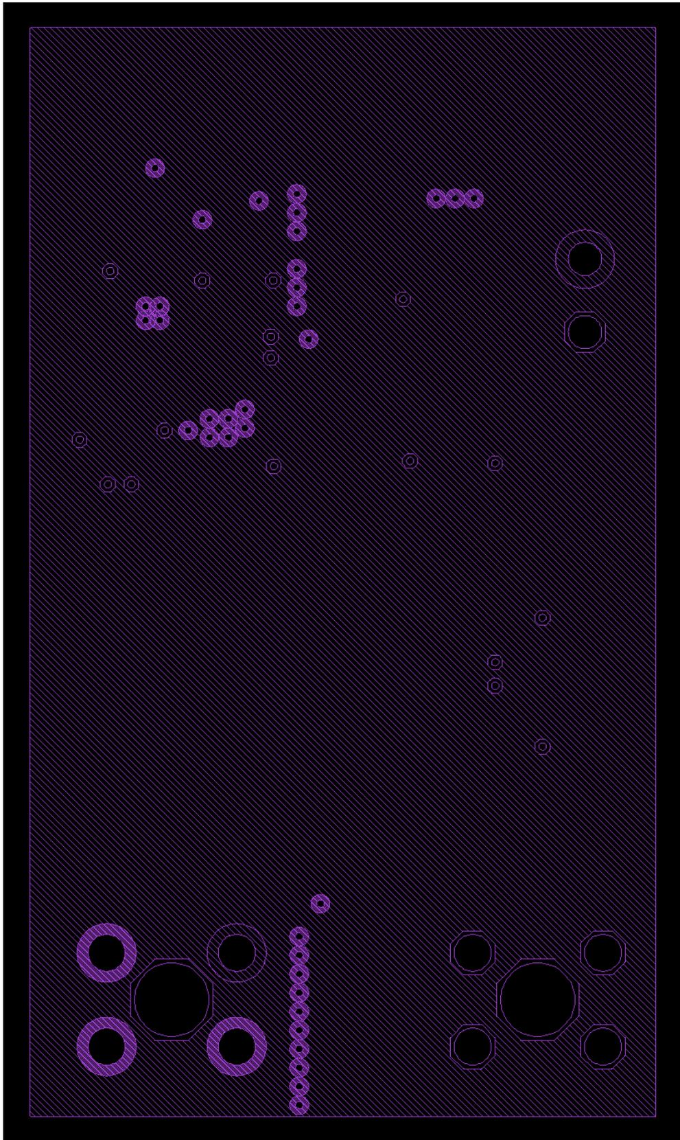
図 3.9 3.3 V/18.2 A 出力 100 % 負荷時効率優先 DC-DC コンバーター PCB パターン (5 層)
