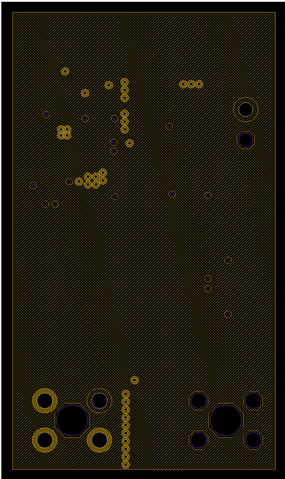
図 3.6 3.3 V/18.2 A 出力 100 % 負荷時効率優先 DC-DC コンバーター PCB パターン (2 層)
