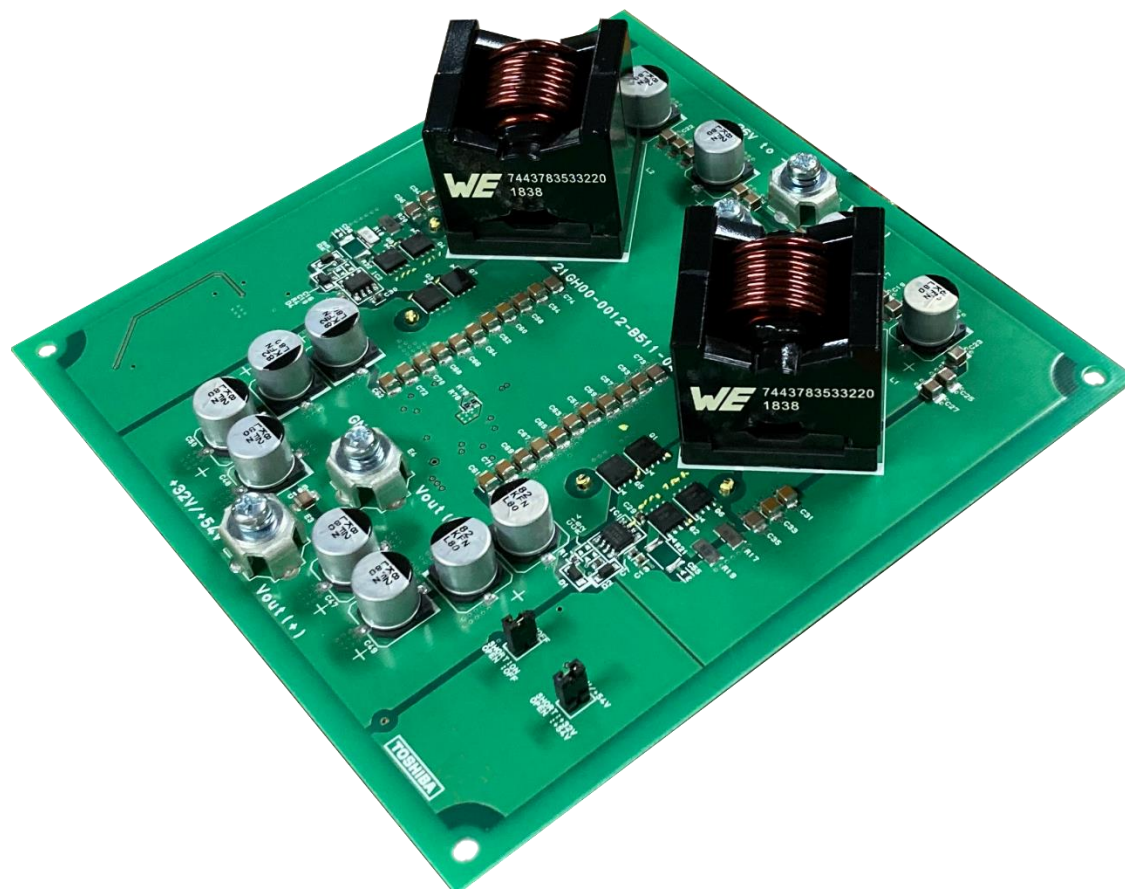
図 2.2 通信機器用非絶縁昇降圧 1 kW DC-DC コンバーターの側面写真
