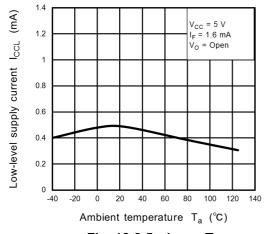
Fig. 12.2.5 I<sub>CCL</sub> - T<sub>a</sub>
