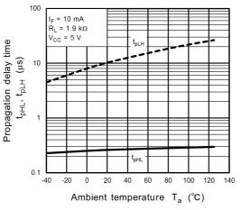
Fig. 12.2.15  $t_{pHL}$ , $t_{pLH}$  -  $T_a$
