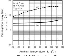
Fig. 12.2.13  $t_{pHL}$ , $t_{pLH}$  -  $T_a$
