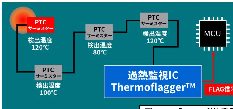
Thermoflagger™と発熱箇所に配置されたPTCサーミスターを組み合わせて異常発熱を監視。
