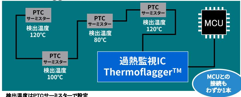
Thermoflagger™はIC内部にコンパレーターと定電流源を搭載し、PTCサーミスターに定電流を流して電圧降下を内部基準電圧と比較します。PTCサーミスター周辺の温度が上昇すると、PTCサーミスターの抵抗上昇により端子電圧が上昇することから、内蔵コンパレーターとの電圧比較により異常発熱を検知できます。
