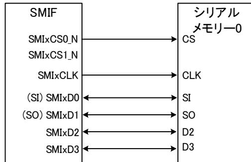
図 5.13 Quad/QPIの接続例 (シリアルメモリー0)
