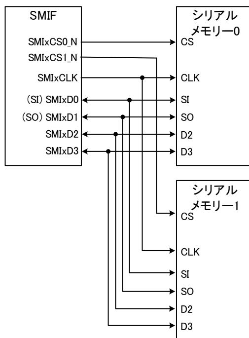
図 5.14 Quad/QPIの接続例 (シリアルメモリー0/1)
