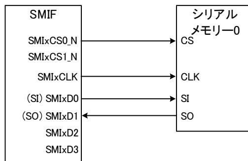
図 5.11 Standard SPIの接続例 (シリアルメモリー0)
