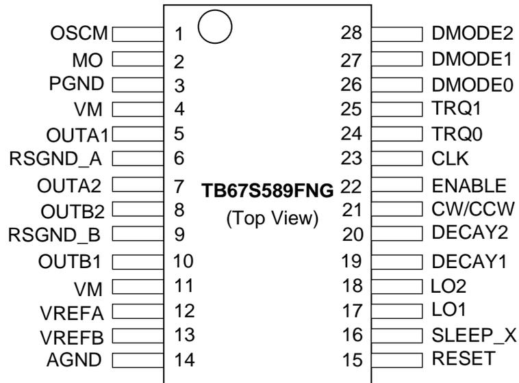
図3 ピン配置図
