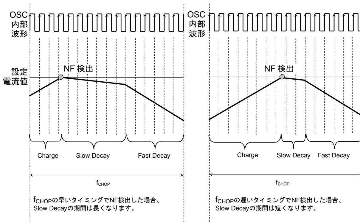
図 7.10 定電流 PWM 動作の各時間
