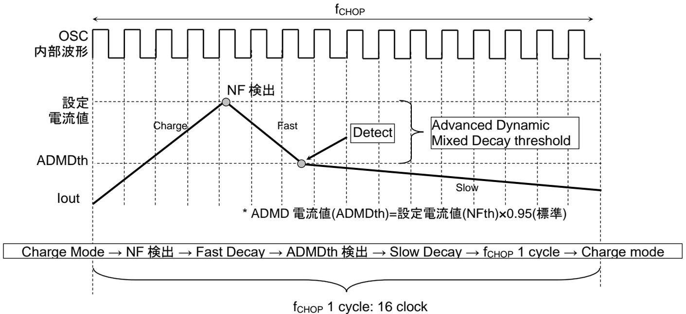
図 7.12.1 ADMD (Advanced Dynamic Mixed Decay) 定電流制御 1
