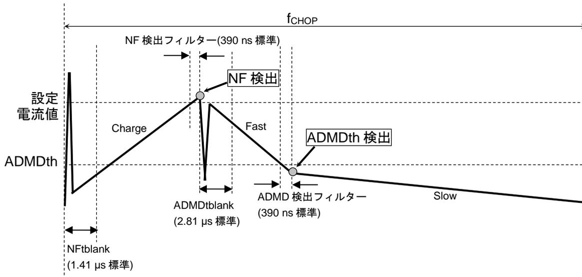
図 7.12.2 ADMD (Advanced Dynamic Mixed Decay) 定電流制御 2
