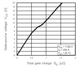
Fig. 8.5 V<sub>GS</sub> -Q<sub>g</sub>
