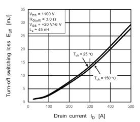
Fig. 8.8 E<sub>off</sub> - I<sub>D</sub>
