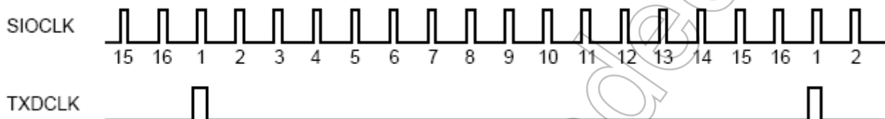
图 12-6 UART 模式中传输时钟脉冲的生成
