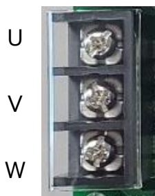
図 4.3 基板上のモーター接続端子(J2)
