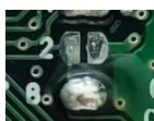
図 4.16 ソルダージャンパーの使用例 (SJP2 がオープン、SJP8 がショートの場合)
