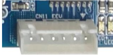
図 4.5 電子拡張弁接続コネクタ (CN11)
