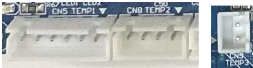
図 4.8 温度センサーコネクタ（CN5, CN8, CN9）
