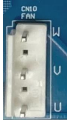
図 4.2 ファンモーター接続コネクタ (CN10)
