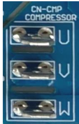
図 4.3 コンプレッサ (CN-CMP)
