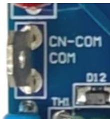
図 4.6 室内機通信端子 (CN-COM)
