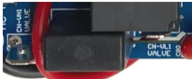
図 4.4 四方弁接続端子 (CN-VL1, CN-VN1)
