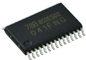
SSOP30-P-300-0.65パッケージ (10.2 x 7.6 x 1.6 mm)
