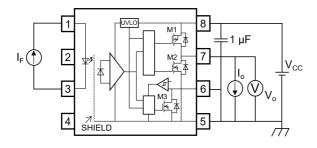
Fig. 13.1.3 V<sub>OH</sub> Test Circuit
