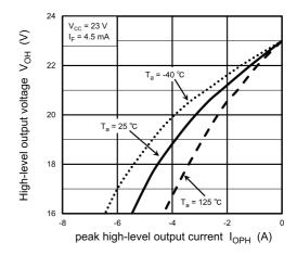
Fig. 13.2.10 (V<sub>OH</sub>-V<sub>CC</sub>) - I<sub>OPH</sub>
