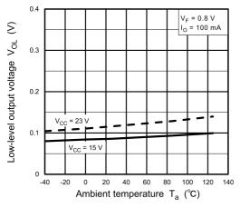
Fig. 13.2.7 V<sub>OL</sub> - T<sub>a</sub>
