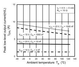
Fig. 13.2.13 I<sub>OHL</sub> - T<sub>a</sub>
