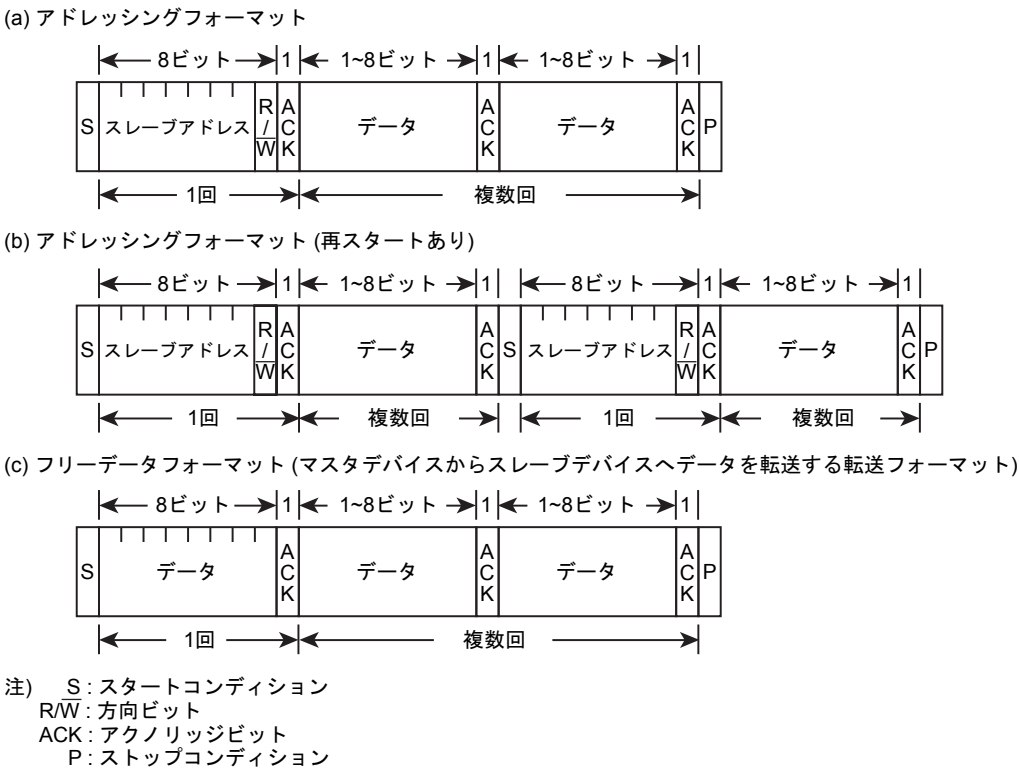
図 13-3 I2C バスモード時のデータフォーマット
