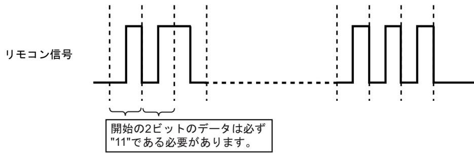
図 18-11 位相方式のリモコン波形例
