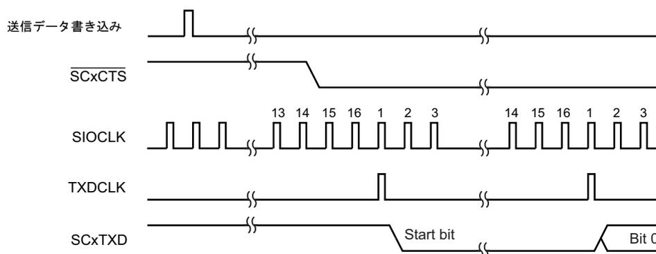
図 13-12  $\overline{\text{SCxCTS}}$  信号のタイミング
