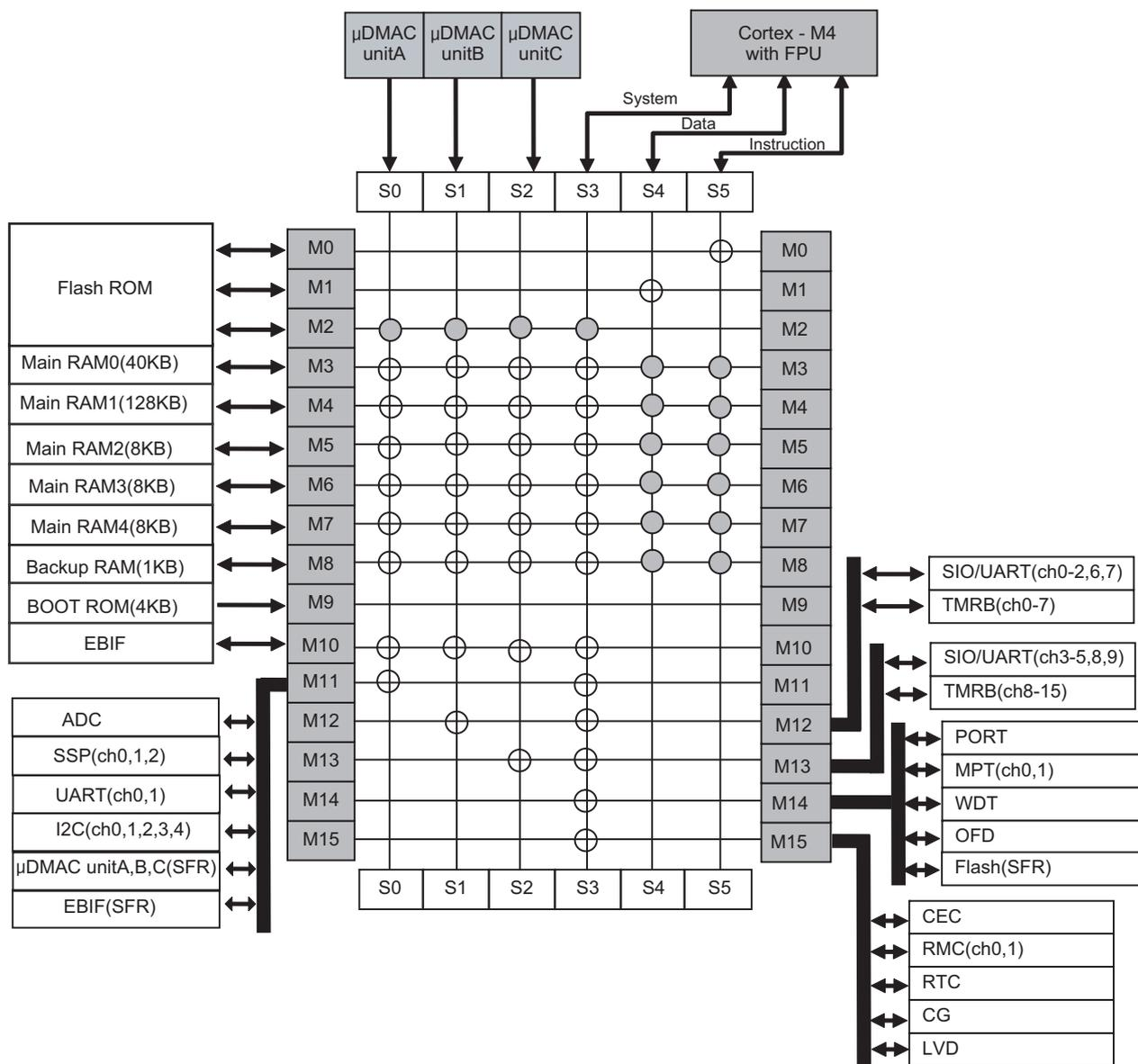
図 4-3 TPM462F15/F10FG のバス構成
