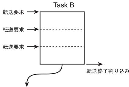
転送要求を受け、DMAは4回の転送を実施します。アービトレーションを実施します。他の優先度の高い要求がない場合、該当チャンネルへの転送要求により4回の転送を実施します。アービトレーションを実施します。他の優先度の高い要求がない場合、該当チャンネルへの転送要求により4回の転送を実施します。転送終了割り込み要求を発生し、アービトレーションを実施します。Task B終了後、Task D用の代替データ設定が可能になります。
