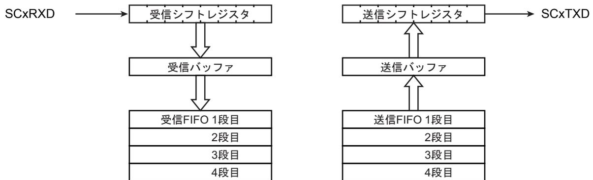
図 13-4 バッファと FIFO の構成
