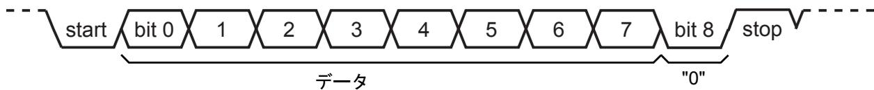
6. <WU>="1"のままのスレーブコントローラは、受信データの最上位ビット(ビット8)の<RB8>が"0"であるため、割り込み(INTRXx)が発生せず、受信データを無視します。また、<WU>="0"になったスレーブコントローラがマスタコントローラにデータを送信し、この送信データで受信終了をマスタコントローラに知らせることもできます。
