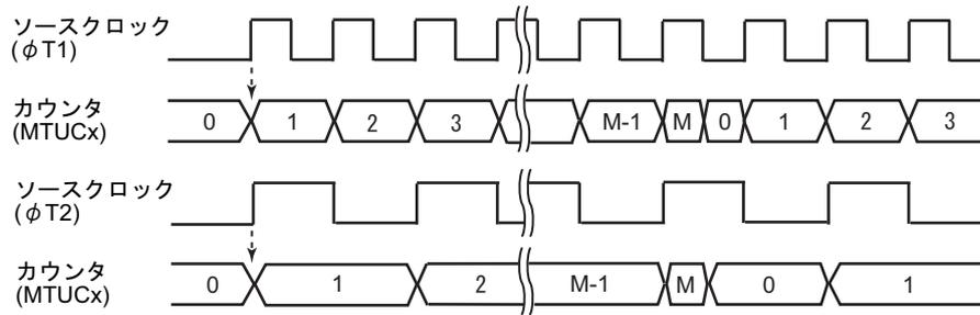
図 12-5 ソースクロック  $\phi T1$ ,  $\phi T2$ ,  $\phi T4$  を選択時のカウントアップ/クリア動作
