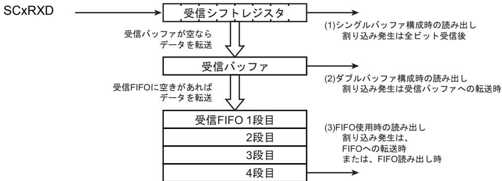
図 13-13 受信バッファ/FIFO 構成図
