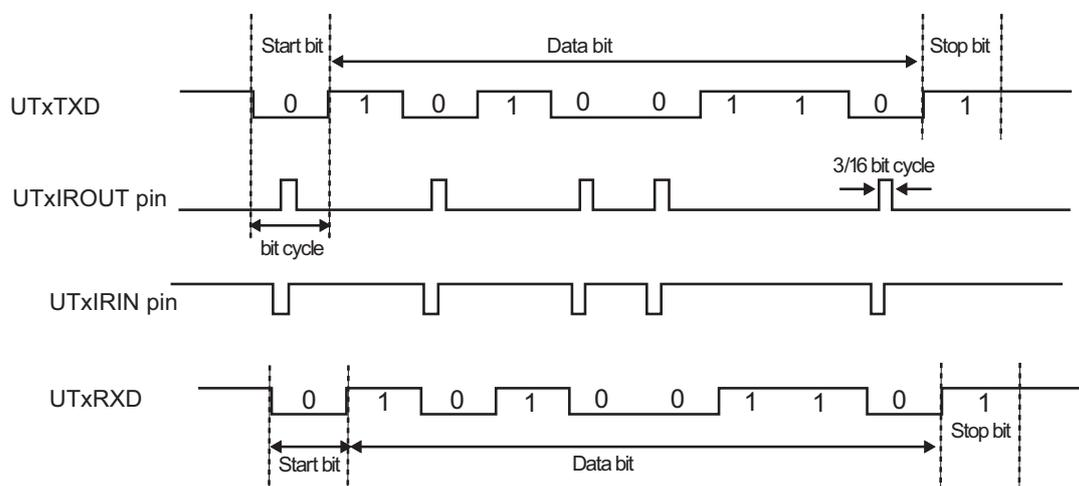
図 14-4 IrDA データ変調の波形
