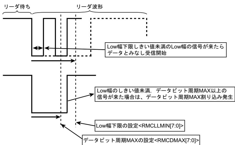
図 18-8 リーダ待ち状態なしでのリーダなしのリモコン信号の場合
