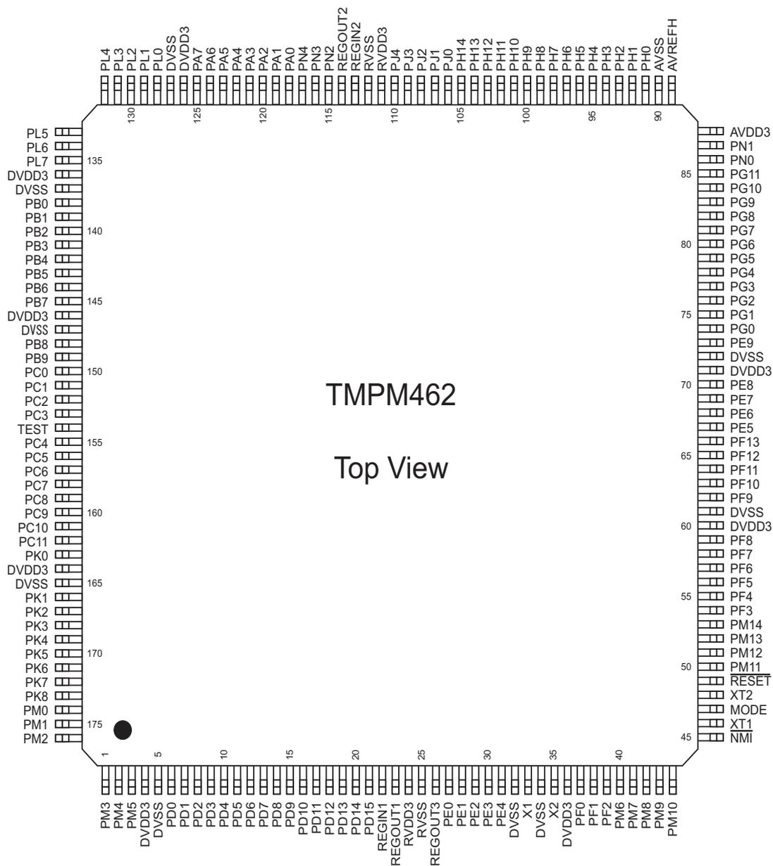
図 1-2 ピン配置図(LQFP176 TOP VIEW)
