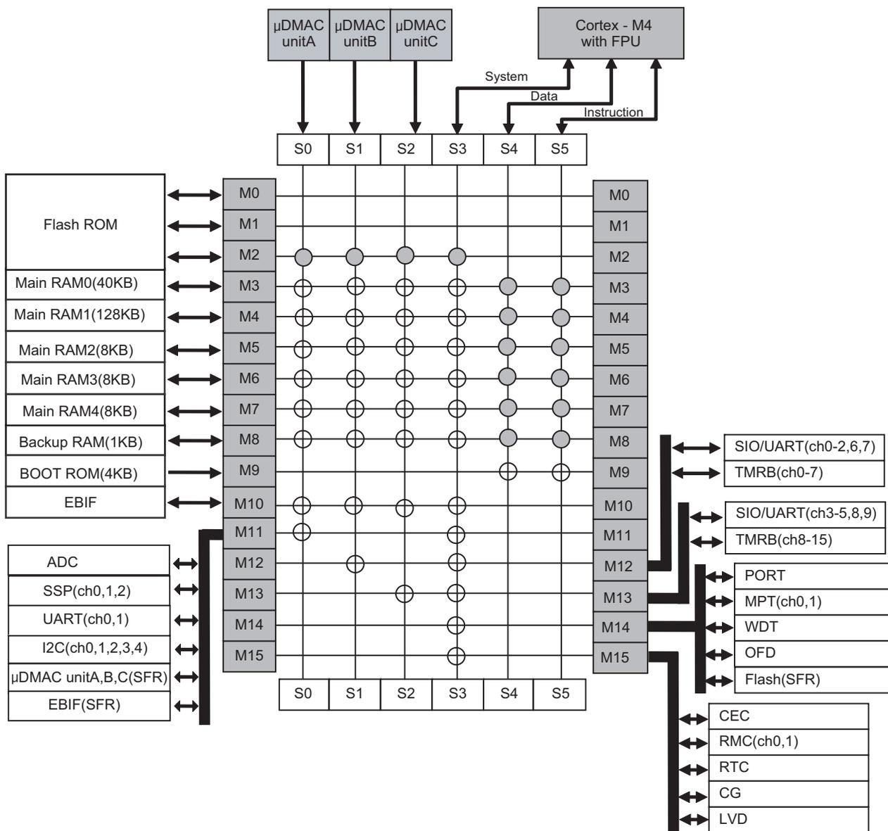
図 4-4 TMPM462F15/F10FG のバス構成
