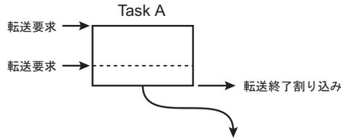
転送要求を受け、DMAは4回の転送を実施します。アービトレーションを実施します。他の優先度の高い要求がない場合、該当チャンネルへの転送要求により残りの2回の転送を実施します。転送終了割り込み要求を発生し、アービトレーションを実施します。Task A終了後、Task C用の1次データ設定が可能になります。
