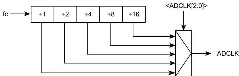
図 19-2 AD 変換クロック(ADCLK)
