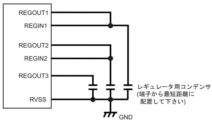
図 1-3 レギュレータ用コンデンサ接続図
