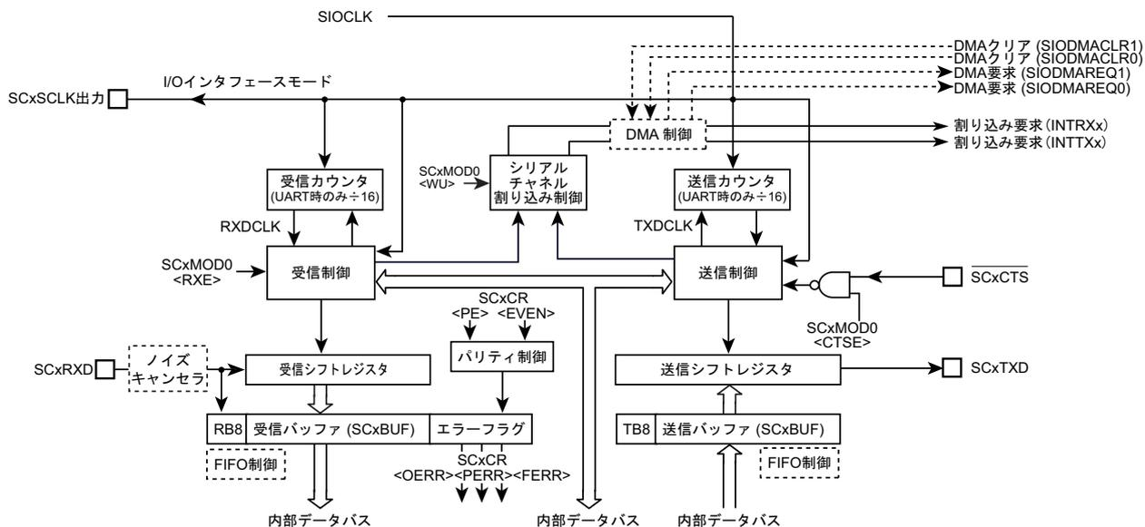
図 13-1 シリアルチャンネルブロック図
