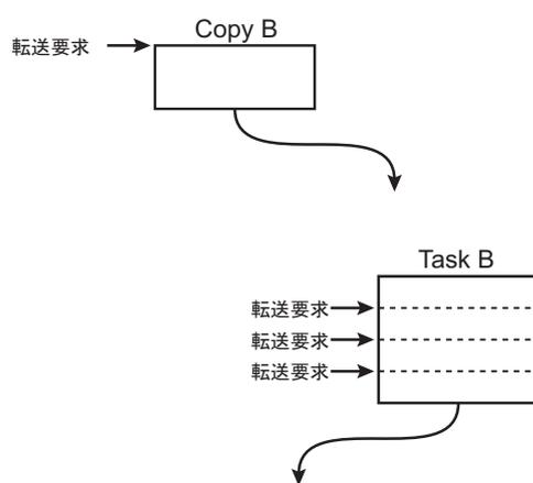
DMA は Task B の代替データ用の 4 回の転送を実施します。
