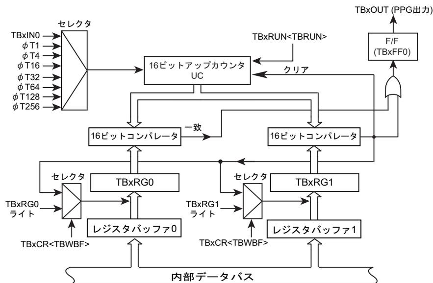
図 11-4 16 ビット PPG モードのブロック図
