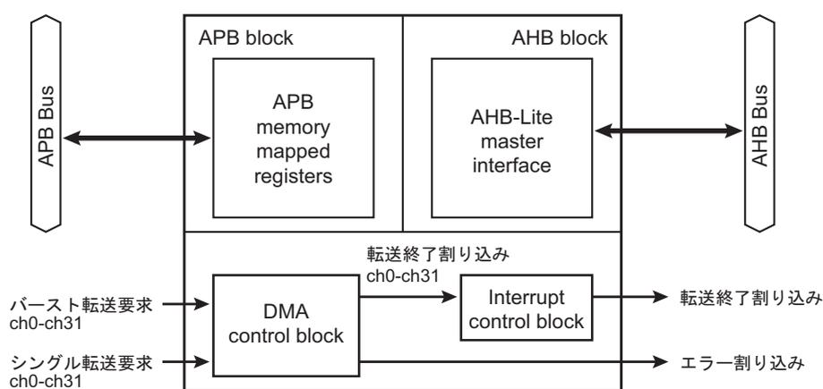
図 8-1 μDMA ブロック図(ユニット共通)
