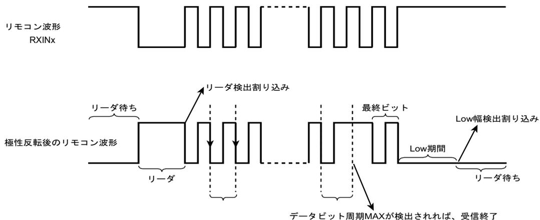
図 18-9 Low 幅のみのリーダで始まるリモコン信号の受信
