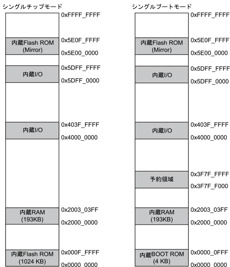
図 24-2 メモリマップの比較(TMPM462F10FG)
