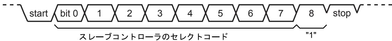
4. 各スレーブコントローラは、上記フレームを受信し、自分のセレクトコードと一致すれば、<WU>を"0"にクリアします。
