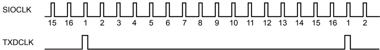
図 13-7 UART モード送信クロックの生成
