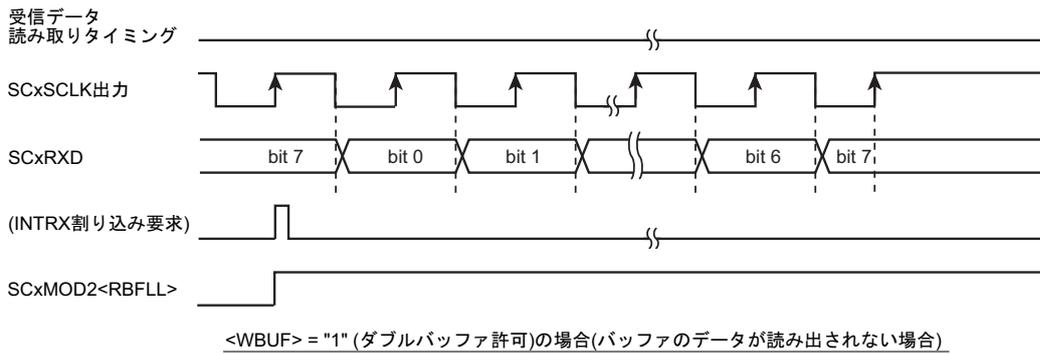
図 13-17 I/O インタフェースモード受信動作(クロック出力モード)
