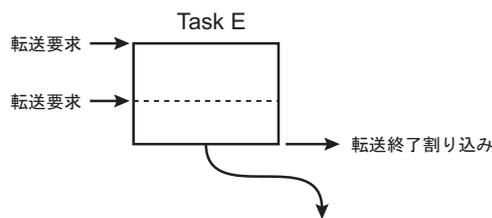
転送要求を受け、DMAは4回の転送を実施します。アービトレーションを実施します。他の優先度の高い要求がない場合、該当チャンネルへの転送要求により3回の転送を実施します。転送終了割り込み要求を発生し、アービトレーションを実施します。
