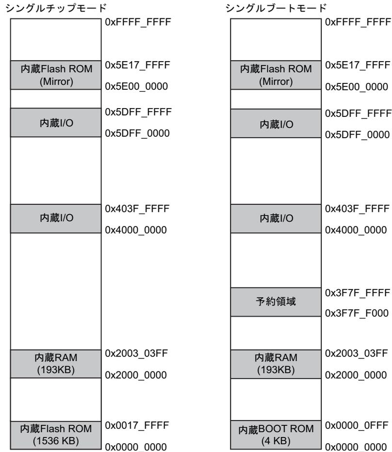
図 24-3 メモリマップの比較(TMPM462F15FG)
