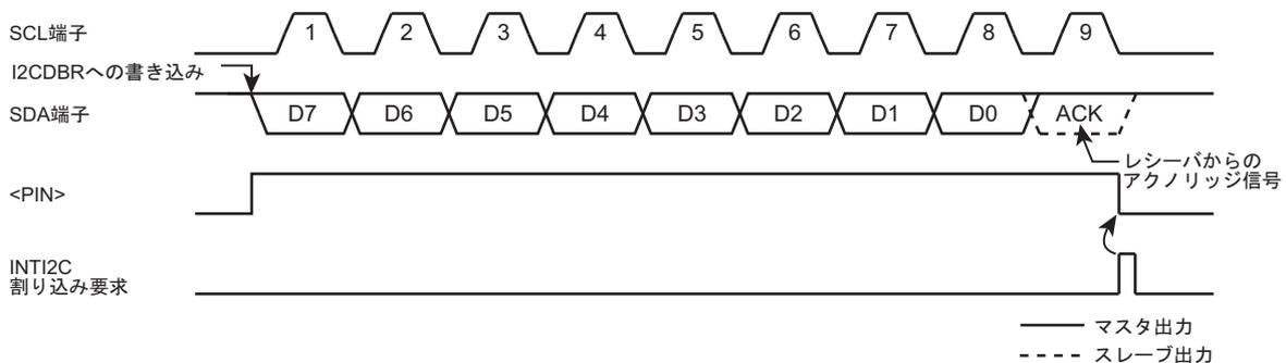
図 15-12 <BC[2:0]>=000,<ACK>=1 の場合 (トランスミッタモード)
