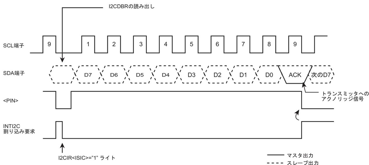
図 15-13 <BC[2:0]>=000,<ACK>=1 のときの例 (レシーバモード)
