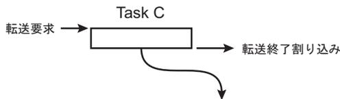
転送要求を受け、DMAは2回の転送を実施します。転送終了割り込み要求を発生し、アービトレーションを実施します。Task C終了後、Task E用の代替データ設定が可能になります。
