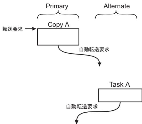
転送要求を受け、DMA は Task A の代替データ用の 4 回の転送を実施します。
