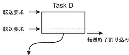
転送要求を受け、DMAは4回の転送を実施します。アービトレーションを実施します。他の優先度の高い要求がない場合、該当チャンネルへの転送要求により1回の転送を実施します。転送終了割り込み要求を発生し、アービトレーションを実施します。
