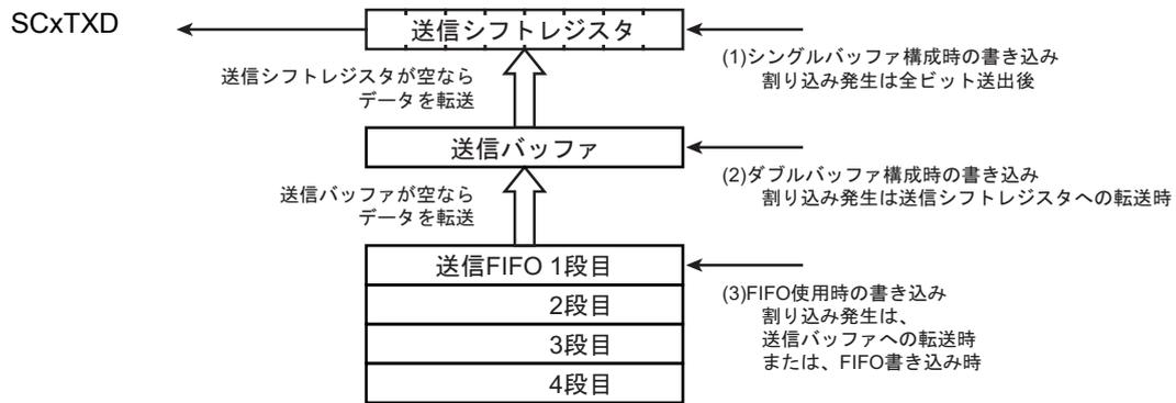
図 13-14 送信バッファ/FIFO 構成図
