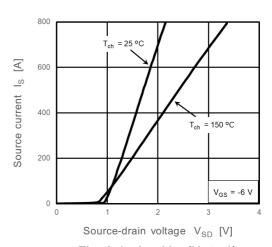
Fig. 8.4 I<sub>S</sub> - V<sub>SD</sub>(Note 1)
