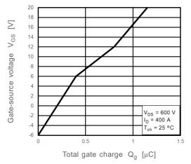
Fig. 8.5 V<sub>GS</sub> -Q<sub>g</sub>
