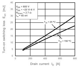
Fig. 8.7 E<sub>on</sub> - I<sub>D</sub>
