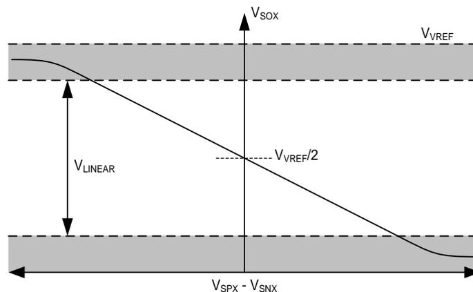
図 11.8 双方向電流検出の出力
