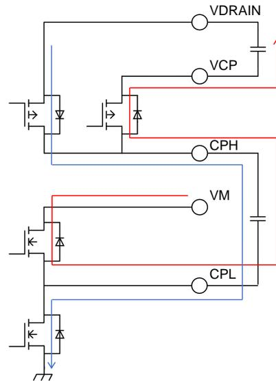
図 11.6 チャージポンプ回路とチャージ電流経路
