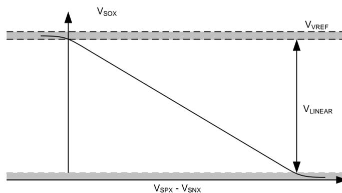
図 11.9 片方向電流検出の出力
