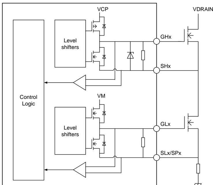
図 11.2 ゲート駆動回路ブロック図
