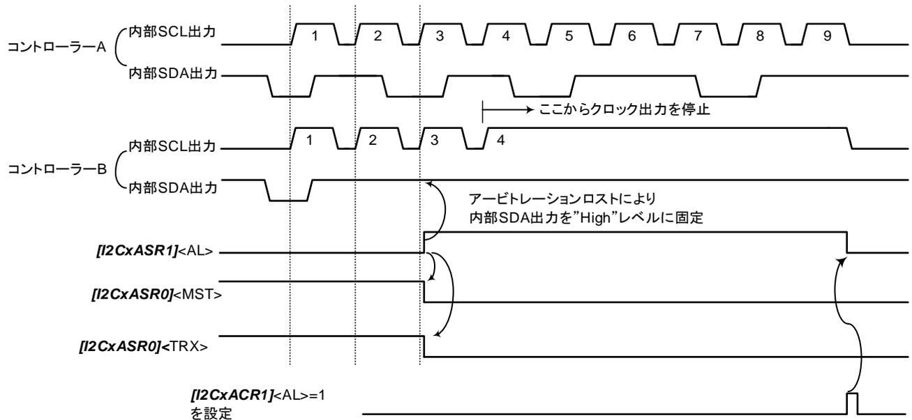
図 3.8 アービトレーションロスト動作 (上記内部フラグはコントローラーBを示す)
