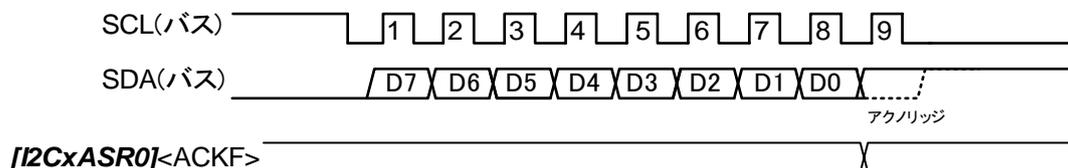
図 3.9 受信ACKビットモニターの変化
