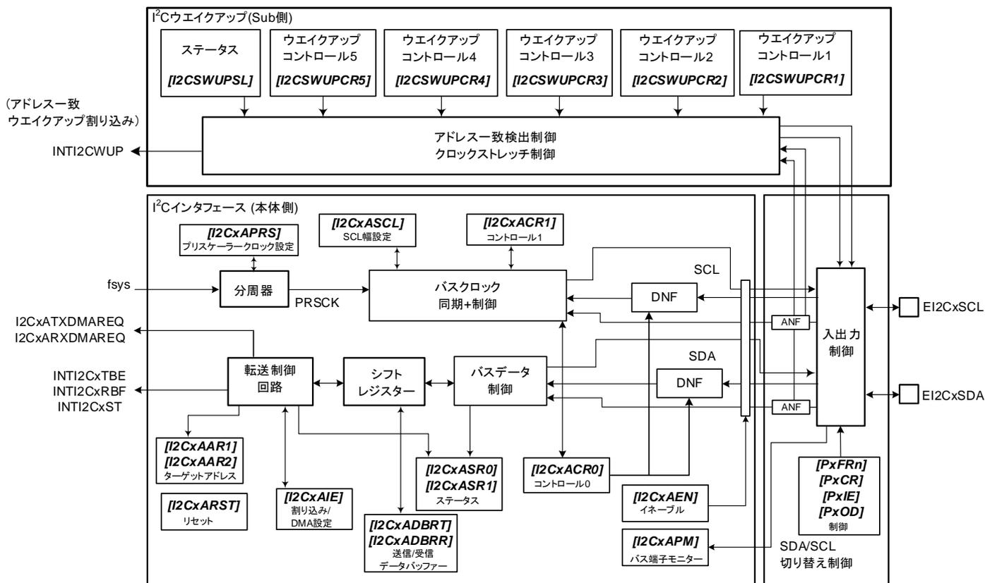
図 2.1 I<sup>2</sup>C インターフェース バージョン A 構成図
