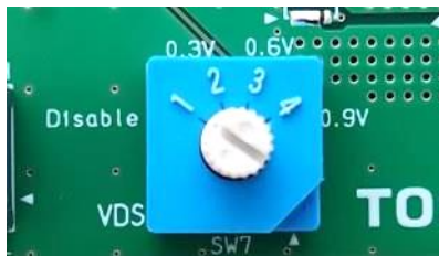
図 4.10 VDSしきい値選択スイッチ (SW7)
