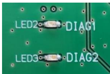
図 4.12 DIAG1 LED (LED2, 赤) および DIAG2 LED (LED3, 黄)
